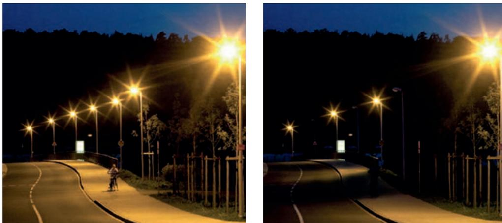
Abbildung 15: Beispiel einer Beleuchtungssituation mit guter (links) und schlechter (rechts) Gleichmäßigkeit © Trilux GmbH
