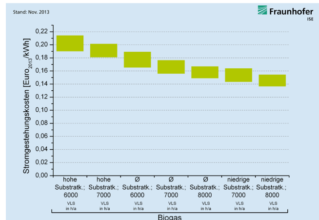
Abbildung 13: Stromgestehungskosten von Biogaskraftwerken bei unterschiedlichen Substratkosten und Volllaststunden im Jahr 2013.
